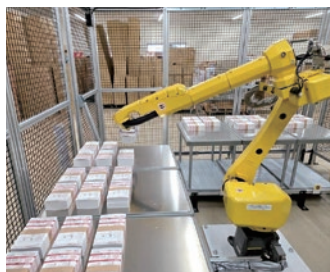
ロボットはファナック製。1日約20万枚の不在連絡票を仕分けできる。
